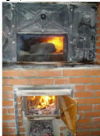
Système à foyer décalé et gueulard connu en France
