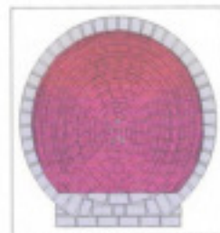
14 ème et dernière assise ; fermeture de la coupole ; le centre de cette assise est en avant du centre de la sole.
