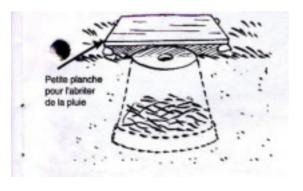
Pour attirer d'autres espèces de bourdons, enterrez le pot, toujours remplis de son bourrage végétal ou artificiel, horizontalement à environ 5 cm sous le niveau du sol. Vous aurez au préalable enfoncé un tube en caoutchouc de 15 mm de diamètre (intérieur) dans le trou de drainage du pot en l'ayant recourbé à 45° pour qu'il émerge verticalement du sol.
