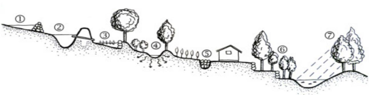
Stopper, stocker, ralentir le flux énergétique, un exemple ici avec l'eau. 1-gabion, 2-mare, 3-rizières, 4-baissière, 5-drain, 6-aquaculture, 7-ombre pour ralentir l'évaporation
